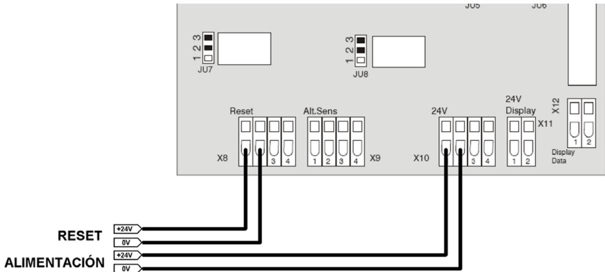
☞ Si el detector TITANUS Pro-Sens TP4 o TP5 está conectado a una Central Algorítmica mediante el interface AE/SA-IT solo es necesario conectar la alimentación de 24V. El envío de información de estado y el raerme se realiza a través del interface.
