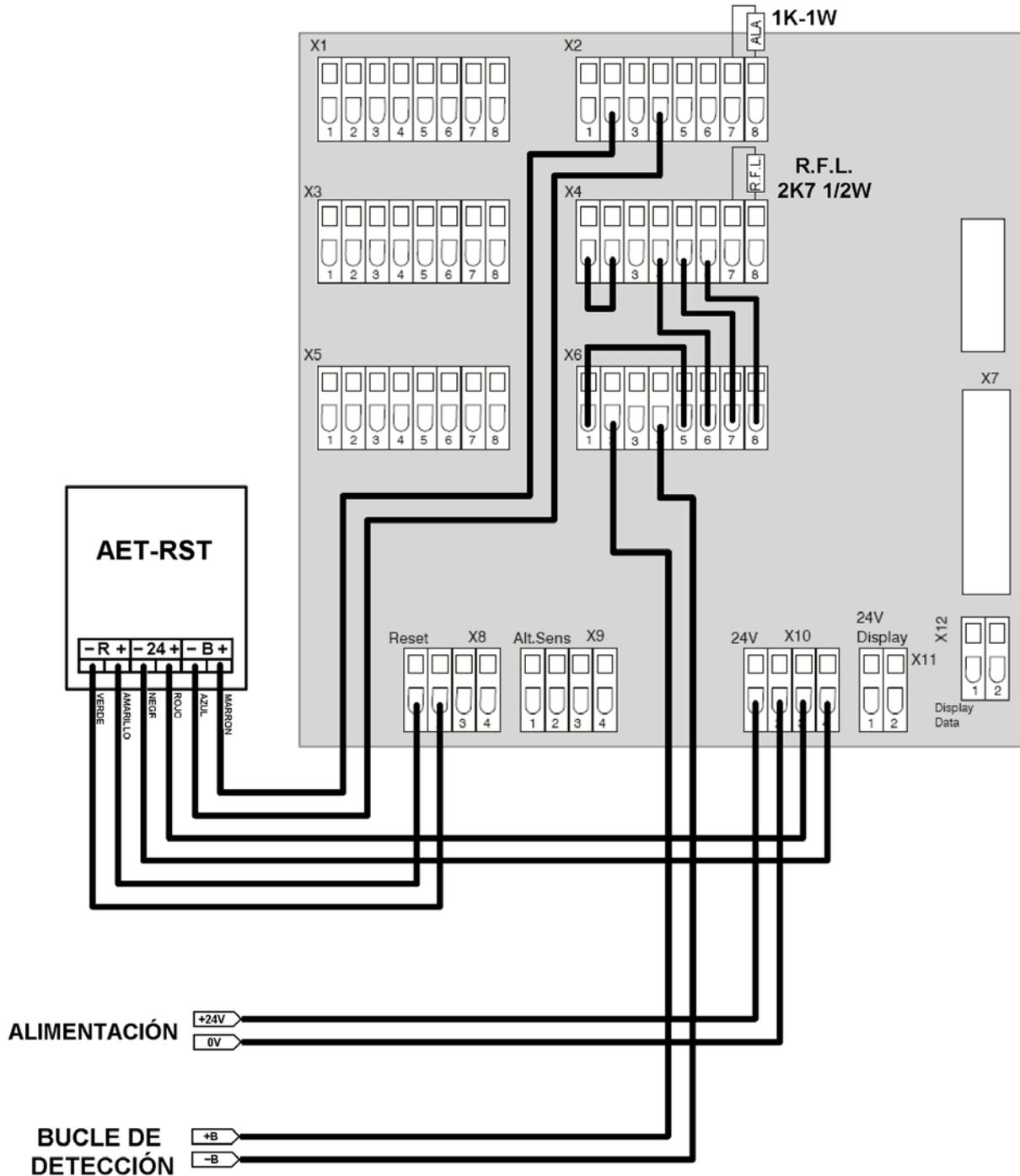
Este conexionado genera estado de 1ª Alarma con el relé de alarma. Si se desea generar 2 niveles de alarma, hay que poner una resistencia de 1K del relé de prealarma.
