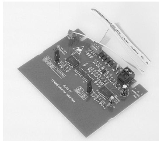
Antes de su conexión, en el interface deben configurarse los selectores SW1 y SW2 en función del equipo y número de módulos detectores instalados.
