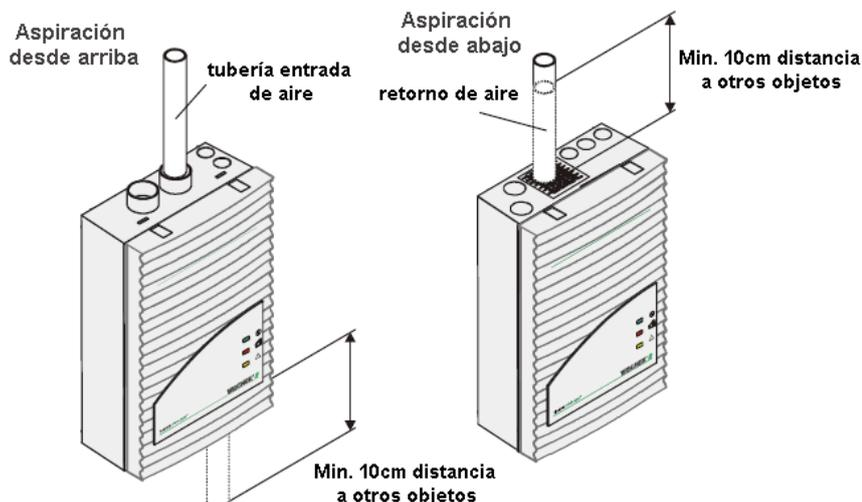
Para realizar un sistema de aspiración desde abajo, hay que girar la caja, y colocar la tapa de modo que los indicadores del frontal se lean correctamente.
