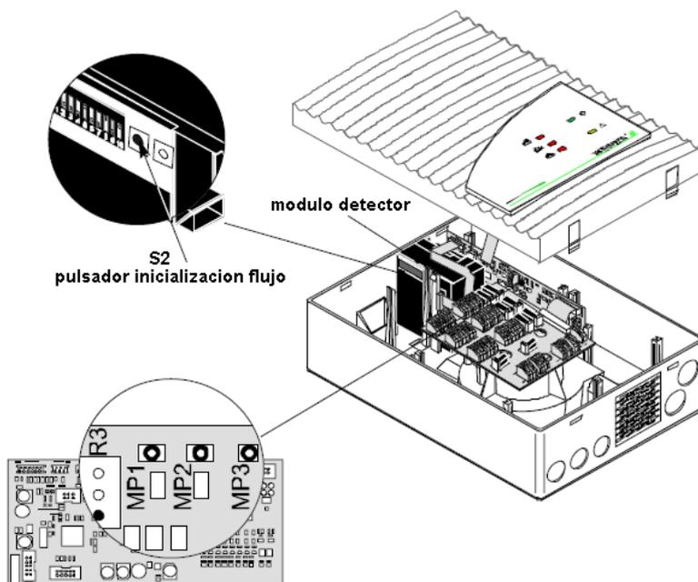
El proceso de inicialización del detector de flujo dura 5sg. Durante este periodo la detección de alarmas es totalmente funcional, el led de estado del módulo detector parpadea, y no deben existir perturbaciones en el flujo de aire.
