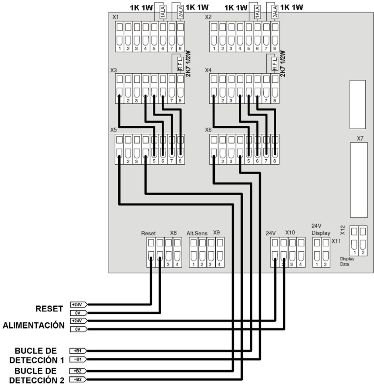
Este conexionado genera estados de 1ª Alarma con el relé de prealarma, y 2ª Alarma con el relé de alarma. Si solo se desea un nivel de alarma, hay que quitar la resistencia de 1K del relé de prealarma.
