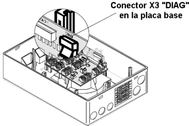
El interface se conecta al detector a través del conector de cinta plana de 6 vías, al conector de diagnóstico X3. Este conector es de tipo Micro-Match y va polarizado.
