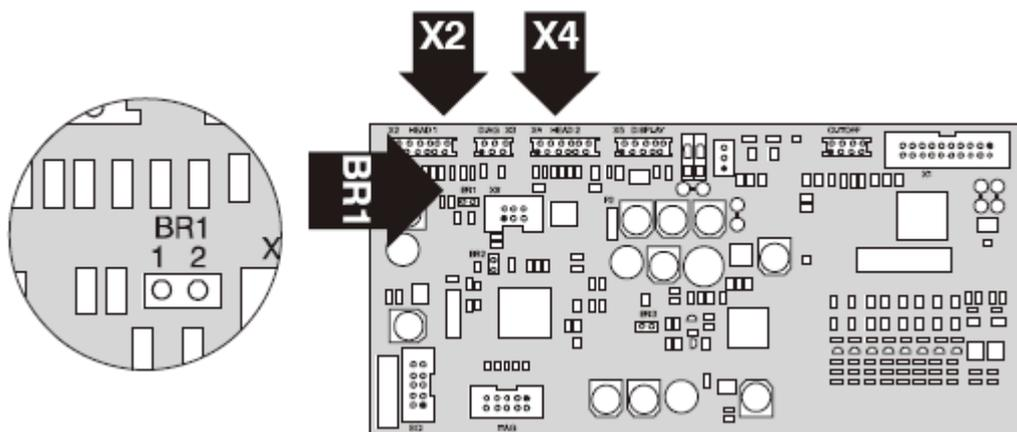
La configuración del modo de funcionamiento del módulo detector se realiza mediante selectores.
