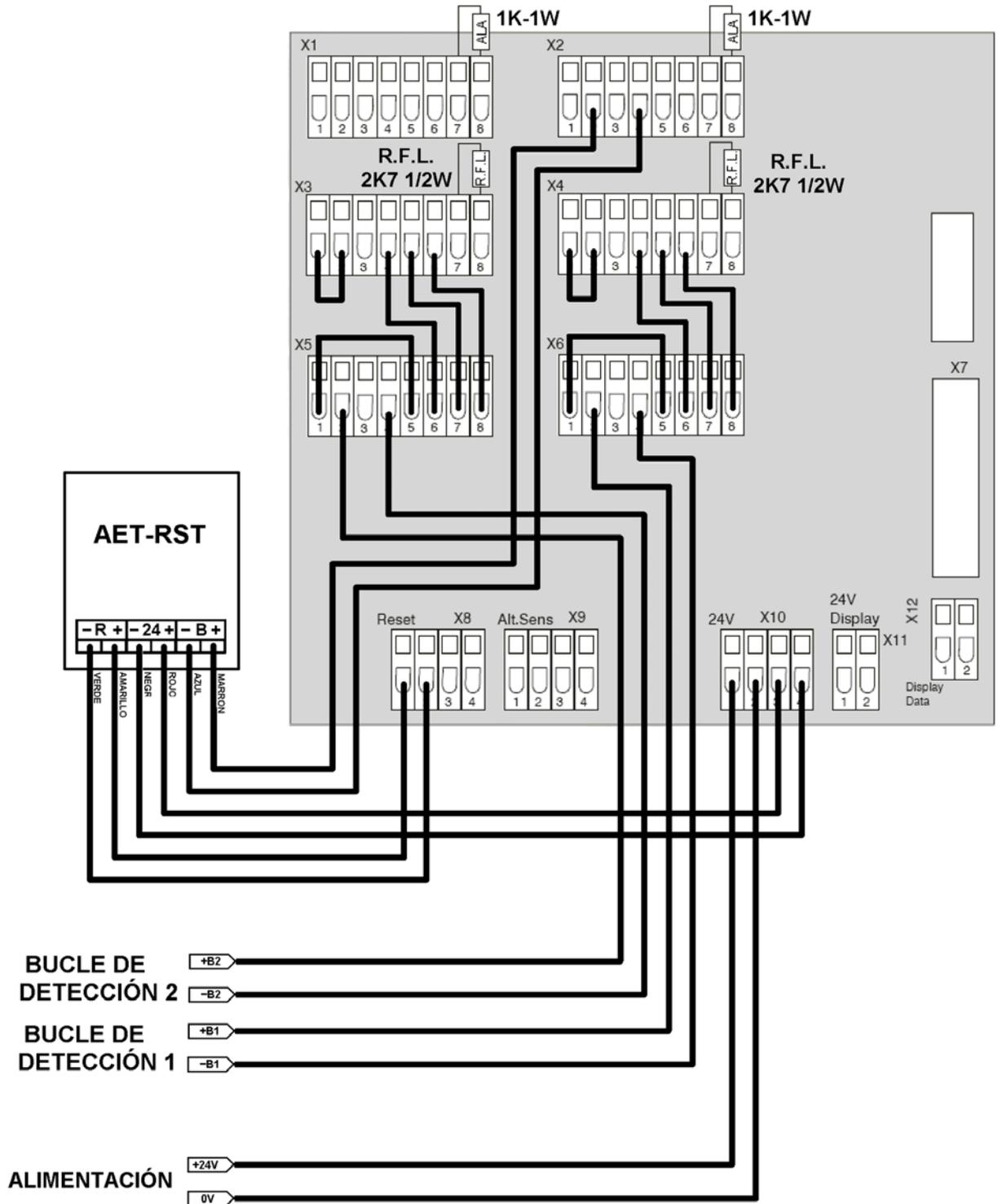
**1.9 CONEXIÓN A PANEL DE EXTINCIÓN AE/PX2.**
