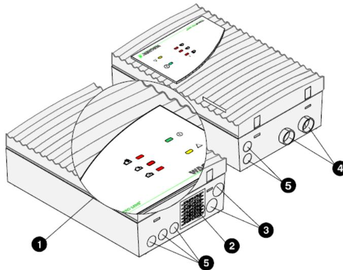
En el interior de la caja se encuentra la placa base, donde se conectan los módulos detectores, y el circuito de conexiones, donde se realizan las conexiones de alimentación, bucles de detección, rearme, etc.
